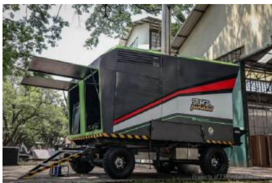
Sumber: Hasil Penelusuran Internet, Tahun 2021 Figure 8. Pindad Production Incinerator
